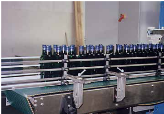
Convoyeur à bouteilles de vin avec tapis 1505
