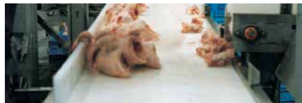
Chaîne de désossage de poulets avec le tapis 2015
