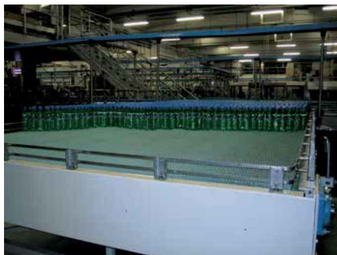
Accumulation de bouteilles sur le tapis 2000
