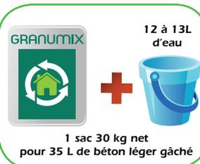
Incorporer 1 sac entier de 35 L dans la bétonnière et ajouter l'eau correspondante (12 à 13 litres/sac). Laisser malaxer 3 à 4 min jusqu'à l'obtention d'une pâte homogène non liquide (le mélange doit être utilisé dans les 40 min qui suivent sa préparation). Ne pas ajouter d'autres composants
